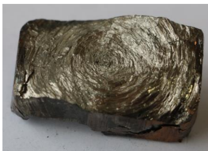
Рисунок 4.34 –Злам зразка, що зруйнувався при ГЕ
