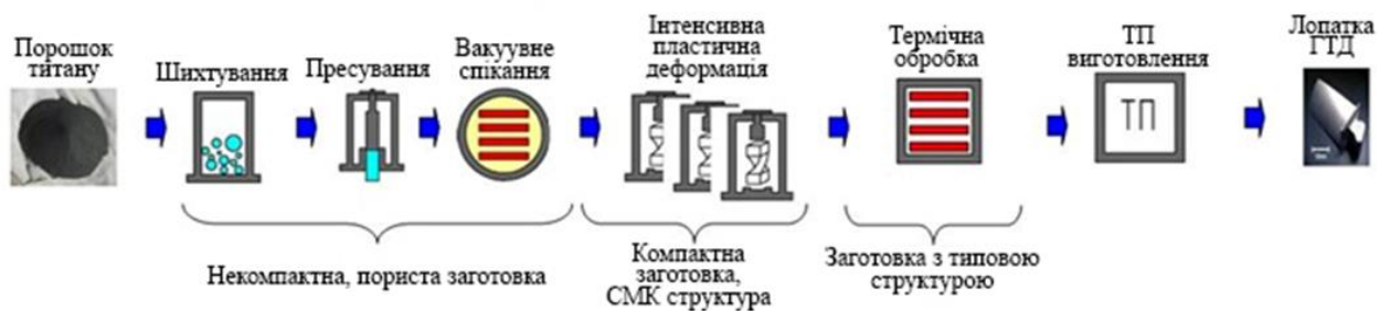
Рисунок 2.12 – Схема технології, основаної на твердофазній ПД-металургії
