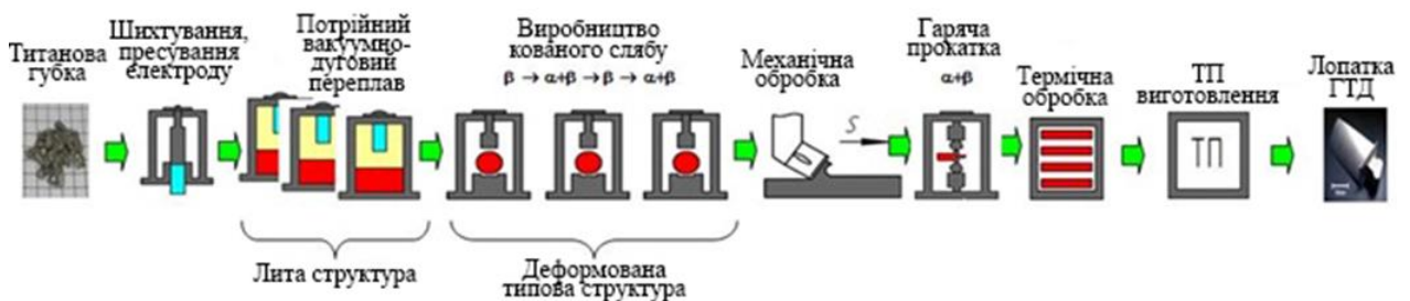
Рисунок 2.9 – Схема технології, основаної на переплаві титану губчатого
